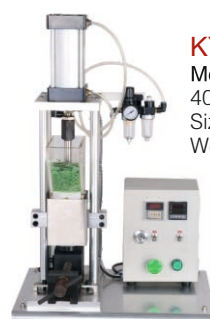
KYG0576 中号钢模注蜡机 Medium Steel Mold Wax Injector 电源供给: 单相 AC110V/220V +10%, 50/60HZ 额定功率: 500W 温度显示范围: 40.0~99.9°C (103~212°F) 温度设定范围: 40~90.0°C (103~193) 温度精度: +1°C 注蜡时间设定范围: 0~99.9(S) 时间精度: 0.1S 压缩空气供给: 6~8 bar 机器气体调压阀调节: 6bar 蜡缸容积: 内径*高度: 36*140MM 钢模尺寸: 1180*70*60MM 三围尺寸: 640x600x922mm 净重量: 108KG
