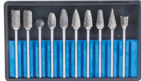
KYG1216 钨钢锉(套装) Tungsten Carbide Rotary Files 锉头Size \phi : 6mm 柄径 \phi : 2.35mm 长度L: 50mm
