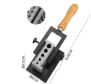
KYG0669 中号圆对平油槽 Ingot Mould 圆形槽直径Φ: 5x7x9x11x13mm 薄片长度L: 80mm 外径尺寸: 26x8x9.5cm 产品重量: 2.32kg
