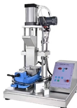
KYG0576 中号钢模注蜡机 Medium Steel Mold Wax Injector 电源供给: 单相 AC110V/220V +10%, 50/60HZ 额定功率: 500W 温度显示范围: 40.0~99.9°C (103~212°F) 温度设定范围: 40~90.0°C (103~193) 温度精度: +1°C 注蜡时间设定范围: 0~99.9(S) 时间精度: 0.1S 压缩空气供给: 6~8 bar 机器气体调压阀调节: 6bar 蜡缸容积: 内径*高度: 36*140MM 钢模尺寸: 1180*70*60MM 三围尺寸: 640x600x922mm 净重量: 108KG
