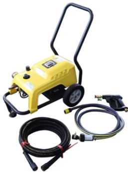
KYG0627 黑猫牌高压清洗机 Black Cat High Pressure Washer 额定压力: 11Mpa Rated pressure 理论流量: 10L/min Flow 额定转速: 2800rpm Rated speed 配套功率: 1.8KW Motive Power 使用电源: 220/50V/Hz Power 整机重量: 34kg Weight
